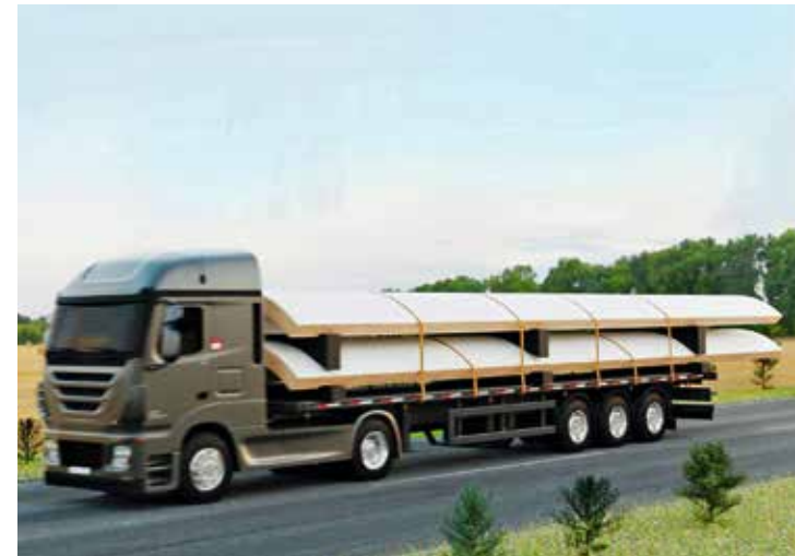
Fundamente und Türme aus Holz lassen sich in kleineren Bauteilen transportieren, was die Anlieferung kostengünstig macht (oben). Die Firma TimberTower errichtete den ersten 100 Meter-Holzturm für eine 1,5 Megawatt Windkraftanlage in Hannover-Marienwerder (rechts).
